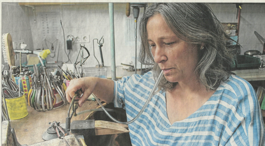
Erfordert Puste: Beim Löten von Metallen reguliert Anett Stephan die Stärke der Flamme durch ihren Luftstrom. Zwei geschmolzene Metalloberflächen werden so zusammengefügt.
